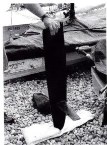
Racks: ein T-Foil Ruder im Mottenstyle. Das Ruder hat im unteren Drittel noch einen Querflügel, der die Längsstabilität des Bootes verbessern soll. Anders als bei den Motten muß für einen 14 der Anstellwinkel des T-Foils allerdings verstellbar sein, um auf den verschiedenen Kursen zum Wind unterschiedliche Aufgaben zu erfüllen. Statt komplizierte Mechanik in das Ruder zu integrieren hat Paul Bieker den Winkel zum Ruder fix gehalten. Muß
